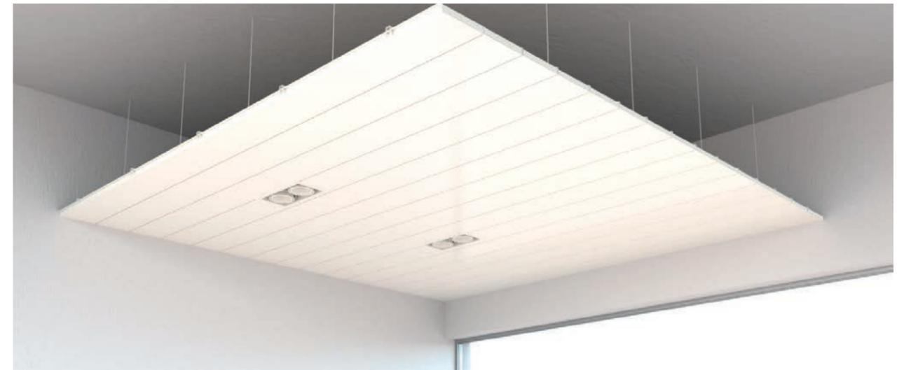
Lamas conformadas por perfilado y plegado, fabricadas con chapa de acero galvanizado prelacado de 0,50 mm de espesor o aluminio prelacado de 0,50 mm (200 Lisa) o 0,60 mm (300) suministrado con film adhesivo de protección.
